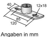
Wird zur Befestigung an einer Wand benötigt.
